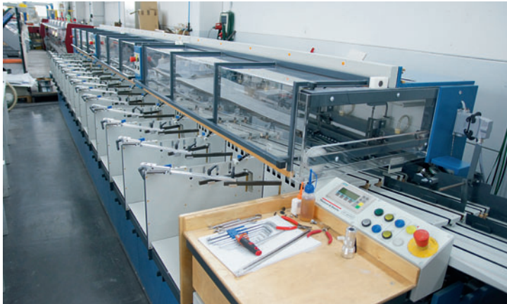
Eine generalüberholte Zusammentragmaschine tb sprint mit 15 Stationen ...
