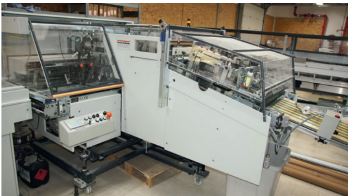
Die tb S 204 QSM-Heft-Falz-Schneid-Maschine dient inline der perfekten Rückstich-Broschürenfertigung – auch für das DIN-A4-Querformat mit Drei-Seiten-Beschnitt.
