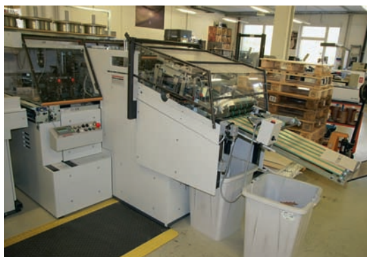
Im Linkslauf der tb flex werden Loseblattwerke mit einem Zwei-Stapel-System zur Auslage (l.) transportiert. Der Rechtslauf übergibt die gesammelten Bögen zur Broschürenfertigung an die tb S 204 QSM mit Drei-Seiten-Beschneidung.
