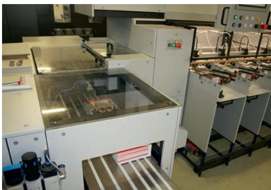
Im Linkslauf der tb flex werden Loseblattwerke mit einem Zwei-Stapel-System zur Auslage (l.) transportiert. Der Rechtslauf übergibt die gesammelten Bögen zur Broschürenfertigung an die tb S 204 QSM mit Drei-Seiten-Beschneidung.
