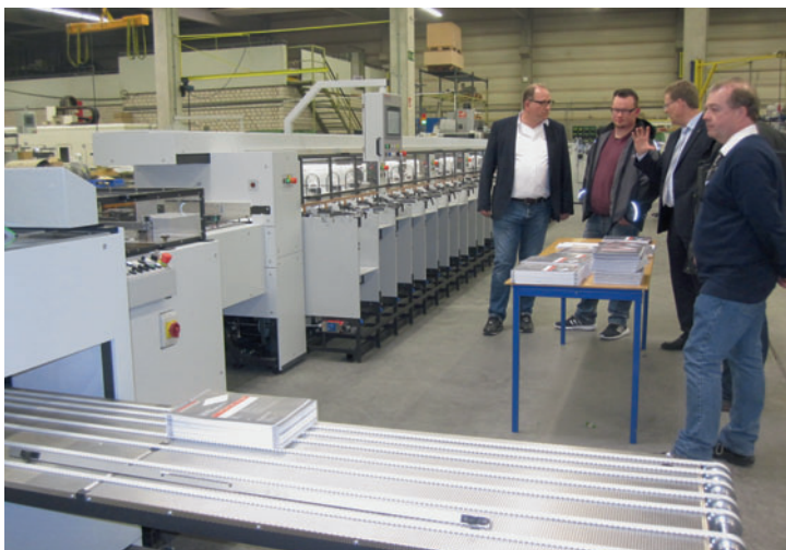
Kontinuierliche Stapelauslage nach einer tb flex B 314 SP.
