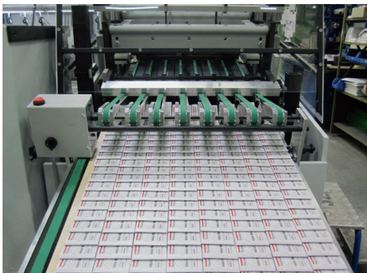
Minihfte in der Auslage der Heft-Falz-Schneid-Maschine tb S 203 QSM.
