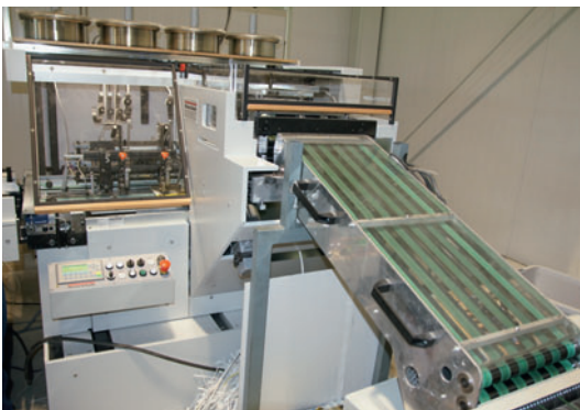
Das Heft-/Falz-/Schneidaggregat tb B 303 QSM dient der automatisierten Broschürenfertigung.
