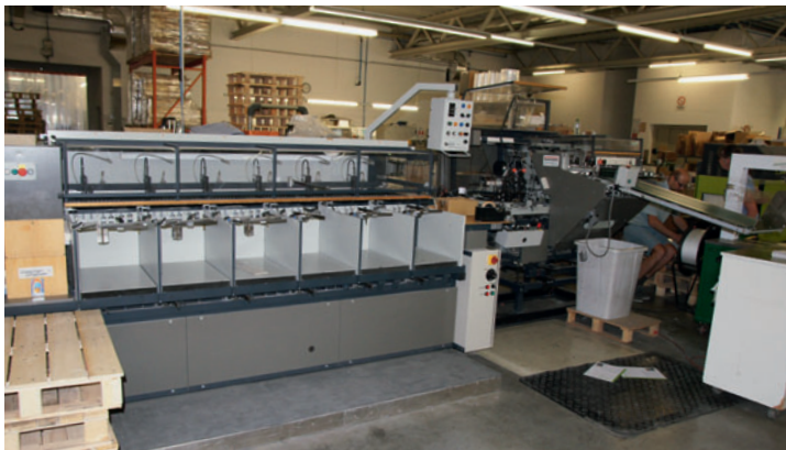
Zwei der vier Theisen & Bonitz-Zusammentragmaschinen sind zum schnellen Wechseln zwischen Zusammentragsätzen im Linkslauf und der Prospektfertigung im Rechtslauf mit einer Broschürenfertigung ausgestattet.
