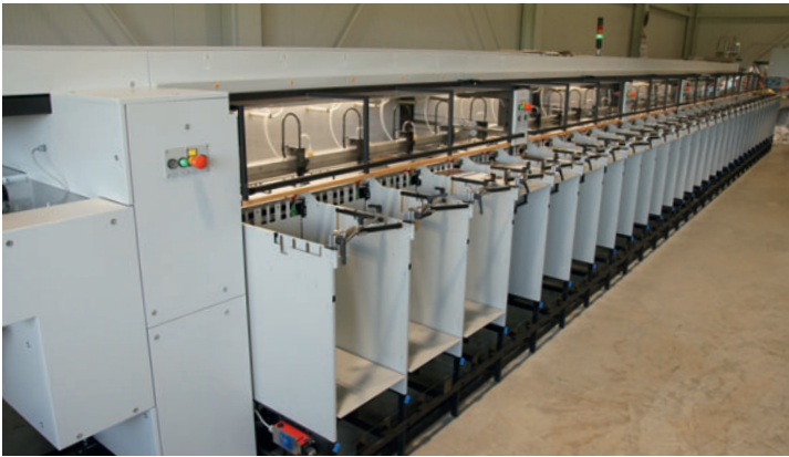
Anfang Mai 2017 wurde der 30 Stationen lange Schnellläufer, der bis 5.000 Takte pro Stunde leistet, von Theisen & Bonitz bei Thurnher installiert.
