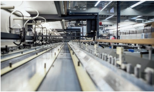
24 Stationen, zwölf Meter lang – so lauten die Eckdaten des Bandtransporttisches der Zusammentragmaschine tb flex B 324 HP.
