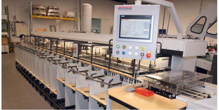
Die Zusammentragmaschine tb flex B 316 SP von Theisen & Bonitz erreicht bei Nino Druck dank der integrierten Wegoptimierung bis zu 4.200 Takte/h.
