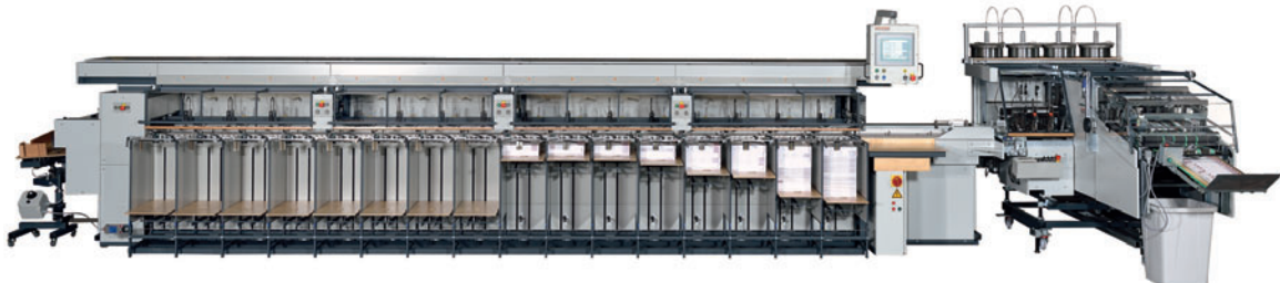
Zusammentragmaschine tb flex B 316 SP, hier kombiniert mit dem Heft-Falz-Schneid-Modul tb S 304 QSM.
