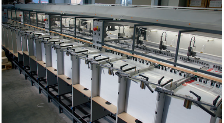
16 Zusammentragstationen dienen im Rechtslauf der Broschürenfertigung.
