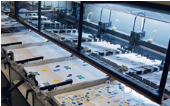
Bewährte Schuppen-Schiebetchnik: das Material wird Takt für Takt an der linken kopfseitigen Kante aufgestoßen.
