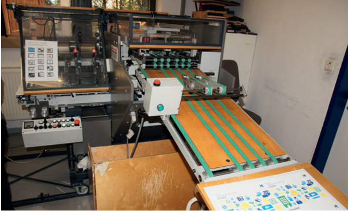
Die ausgetauschte Heft-Falz-Schneid-Maschine tb 303 QSM zur Broschürenfertigung kommt jetzt auch für Heftumfänge von über 40 Seiten zum Einsatz.
