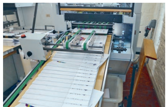
Im Linkslauf werden Sätze gezählt und in bis zu 15 cm hohen Stapeln gesammelt, die kontinuierlich auf die Bandauslage fahren. Im Rechtslauf steht die vollautomatische Broschürenfertigung tb S 203 QSM zur Verfügung.
