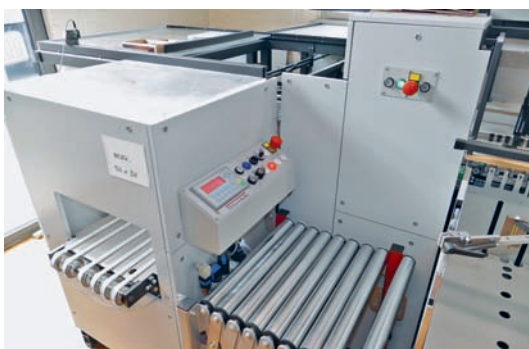
Im Linkslauf werden Sätze gezählt und in bis zu 15 cm hohen Stapeln gesammelt, die kontinuierlich auf die Bandauslage fahren. Im Rechtslauf steht die vollautomatische Broschürenfertigung tb S 203 QSM zur Verfügung.
