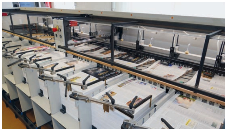
Eine Fehl- und Doppelblatt-Kontrolle per Ultraschall pro Station gehört bei der tb-sprint B 310 SP der Wetterauer Druckerei zur Ausrüstung dazu.
