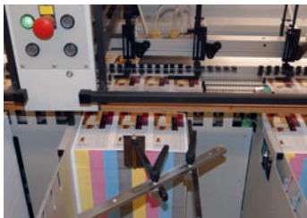
SP steht für Stapel bis 55 cm Stapelhöhe. Diese wird über einen kapazitiven Sensor abgefragt.
