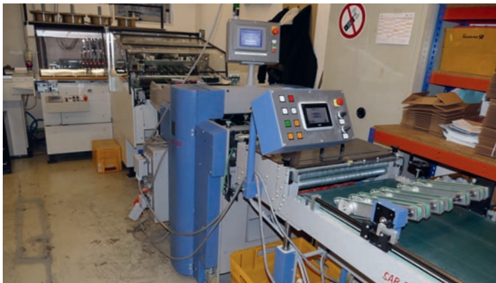
Eine Flachbett-Stanzmaschine BS Multi 450 Servo von Bograma findet bei Braun hinter dem Heft-Falz-Schneidaggregat tb B 204 QSM von Theisen & Bonitz inline ihren Einsatz. Sie schneidet, stanzt, locht oder perforiert.
