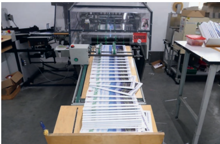
Fertig produzierte Broschüren mit Rückstichheftung werden auf die Auslage des Heft-Falz-Schneidaggregats tb B 304 QSM geschoben.
