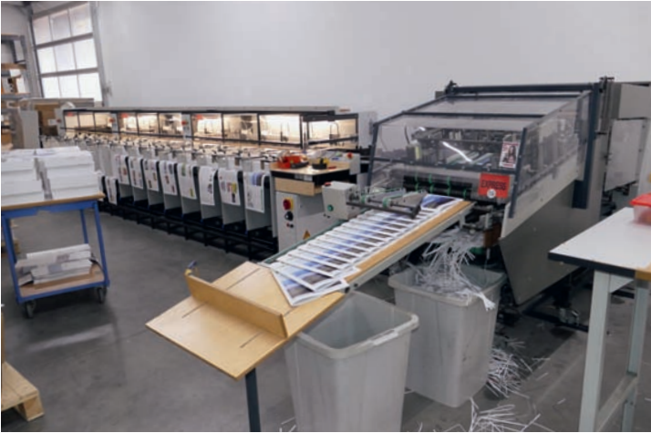
15 Stationen und ein Heft-Falz-Schneidaggregat von Theisen & Bonitz bilden die schnelle und sichere Broschürenfertigung bei Ulenspiegel Druck.
