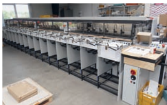
Die neue tb sprint mit 16 Stationen für das Maximalformat 46 x 65 cm.
