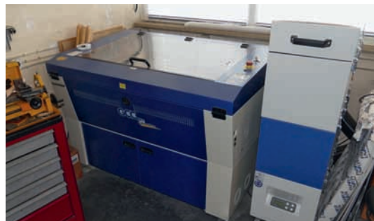
Der CO 2 -Laser von GCC dient Lorch zum Gravieren und Stanzen. Damit hat man sich auch eine Sonderstellung beim Veredeln von Druckprodukten erarbeitet.
