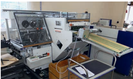
Die Heft-Falz-Schneid-Maschine tb B303 QSM wurde bereits vor rund sieben Jahren bei Lorch eingebracht und wird an der neuen tb sprint weiter eingesetzt.
