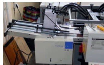
Ein Schneider SF 80-Kuvertanleger hilft beim automatisierten Bedrucken von Umschlägen an der Ryobi.
