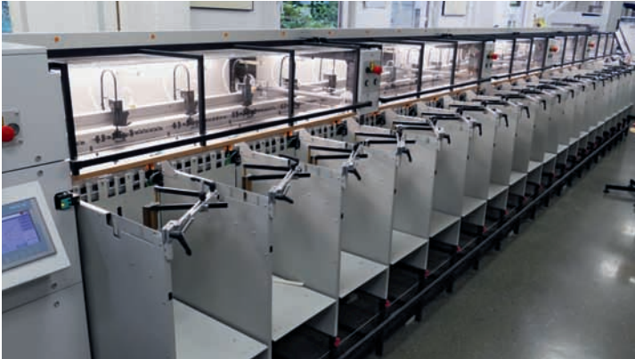
Mit 20 Stationen leistet die tb flex B 320 SP von Theisen & Bonitz bis zu 5.000 Takte pro Stunde und bietet eine automatische Formateinstellung.
