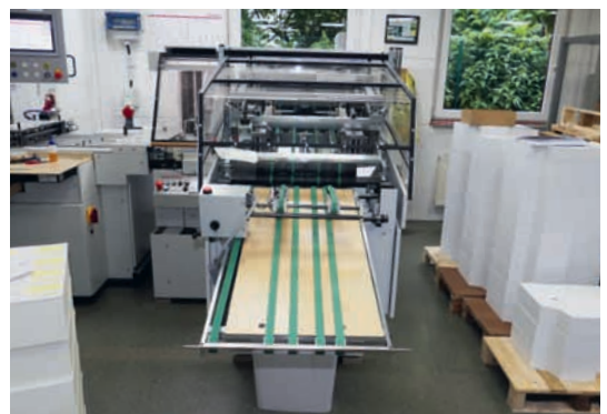
Im Linkslauf endet die tb flex in der tb-Stapelauslage, wo Sätze gezählt und zu Stapeln bis zu einer Höhe von 15 cm gesammelt werden und als Normal- oder Versetzt-Auslage aufs Band geraten. Im Rechtslauf endet das Zusammen-tragen in der Broschürenfertigung tb B 304 QSM, wo unter anderem der Drei-Seiten-Beschnitt vorgenommen wird.
