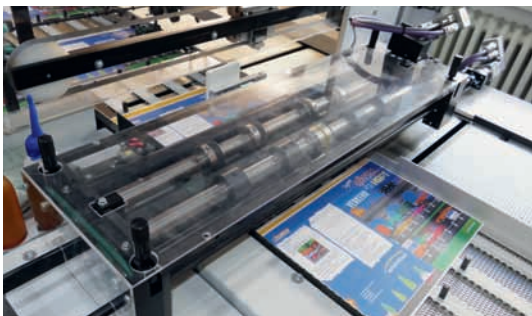
Die Umschlag-Rilleinrichtung mit motorischer Verstellung gehört zur optionalen Ausstattung der tb flex.
