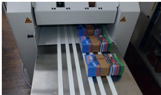
Eine palamides-Auslage der neuen Generation gamma 502 bündelt die fertigen Produkte am Ende der Anlage.
